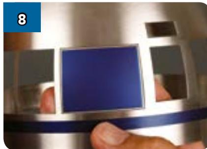
8 Аккуратно вставьте панель в отверстие до конца так, чтобы с наружной стороны она была вровень с поверхностью купола.
